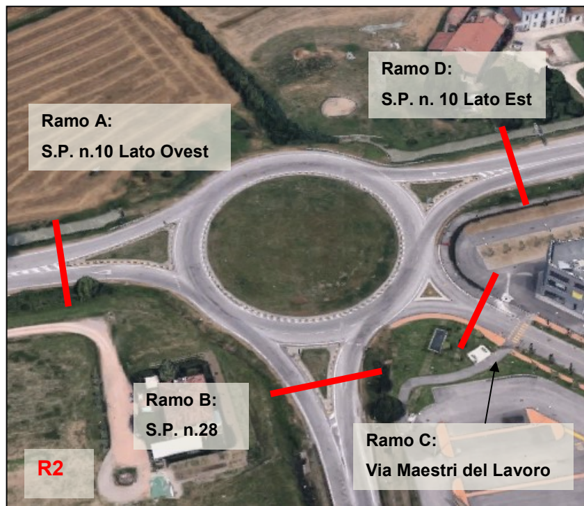
Immagine 6.2: Intersezione R2 tra la S.P. n. 10, la S.P. n. 28 e Via Maestri del Lavoro. Definizione dei rami per la lettura delle matrici Origine/Destinazione
